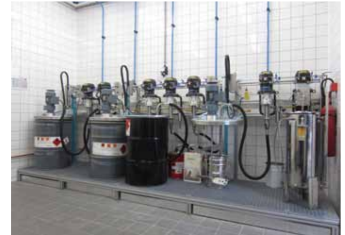
De Wagner pompinstallatie gekoppeld aan de Wagner digitale doseer- en menginstallatie. (Foto: WSB Wagner)
